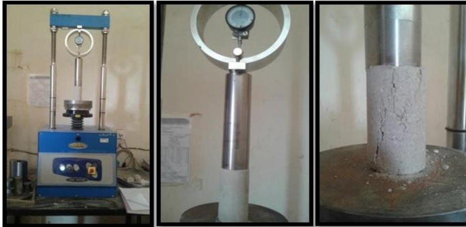
Photo II.13: Ecrasement des éprouvettes dans Presse CBR .
