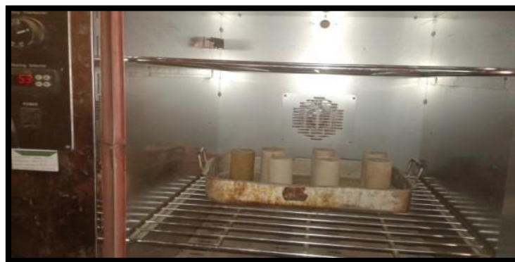
Photo II.12: Conservations des éprouvettes à l'étuve
