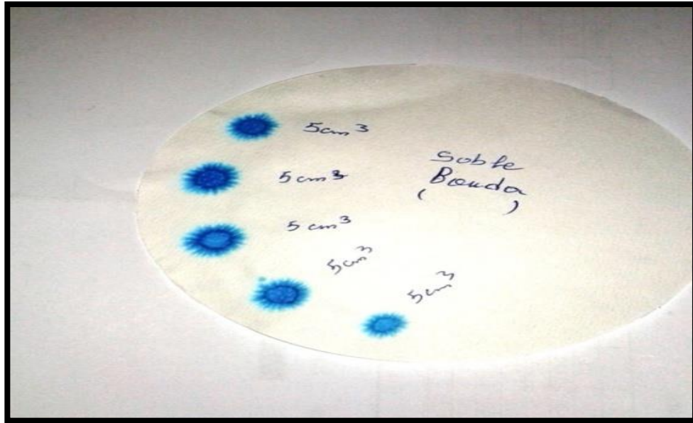
Photo II.6: Papier filtre de l'essai au bleu de méthylène du sable de dunes (BOUDA)
