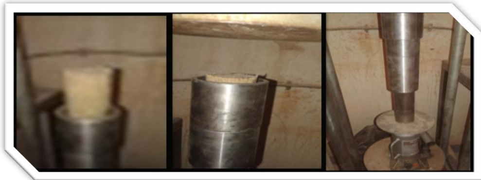
Photo II.11: Compactage statique et démoulages des éprouvettes
