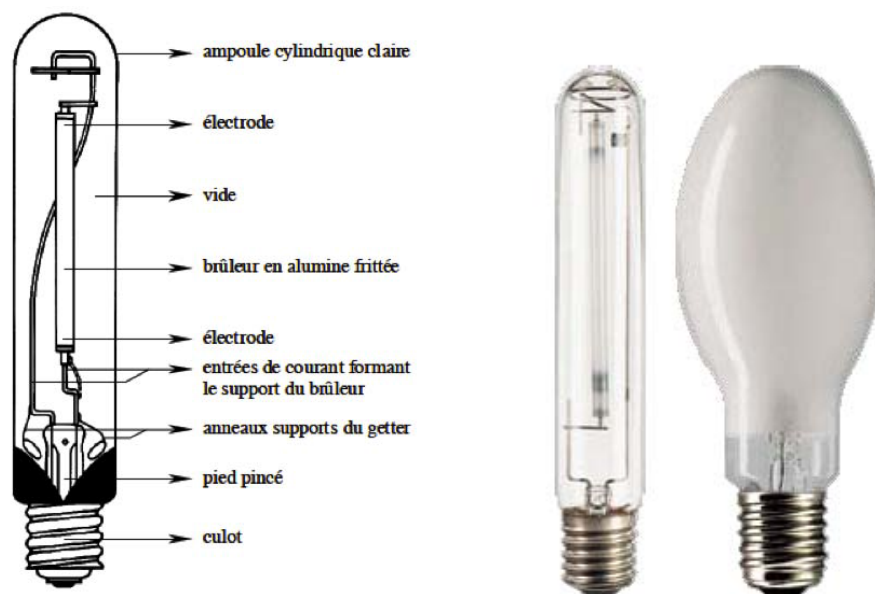
Figure 2- 5 Lampe haute pression à vapeur de sodium [19]
