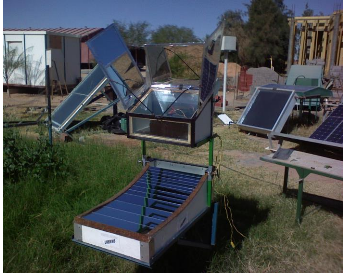
الشكل 5: صورة نموذج المطبخ الشمسي المزدوج الالتقاط المصنوع ب "و.ب.ط.م.و.ص" بأدرار.
