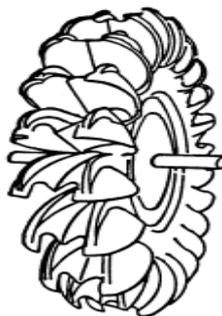
*Figure 2 : Vue globale d'une turbine Pelton*
