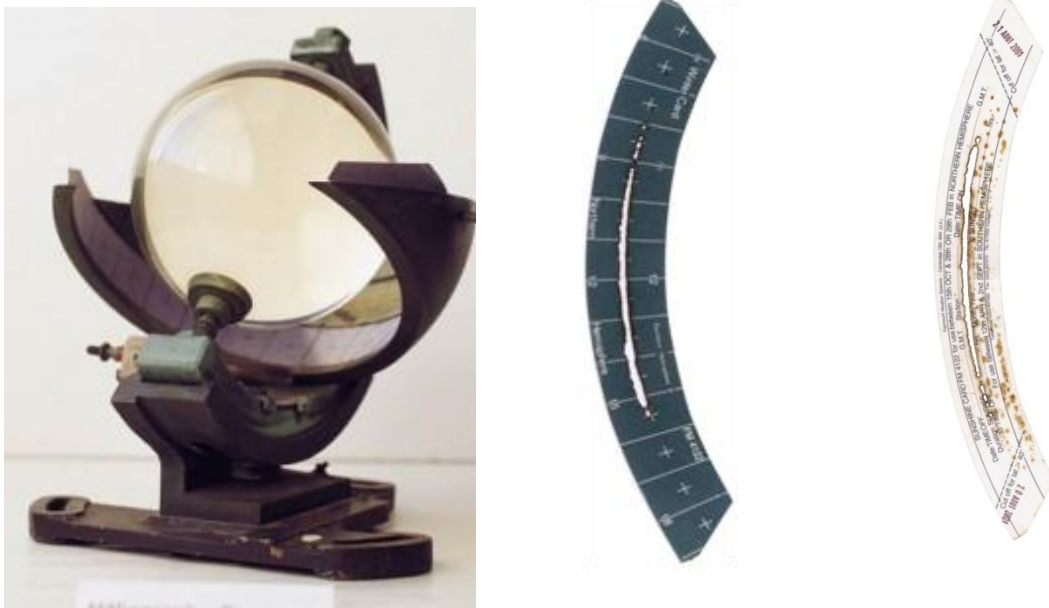
Figure I. 5. Héliographe de Campbell-Stokes et la bande de papier utilisé.
