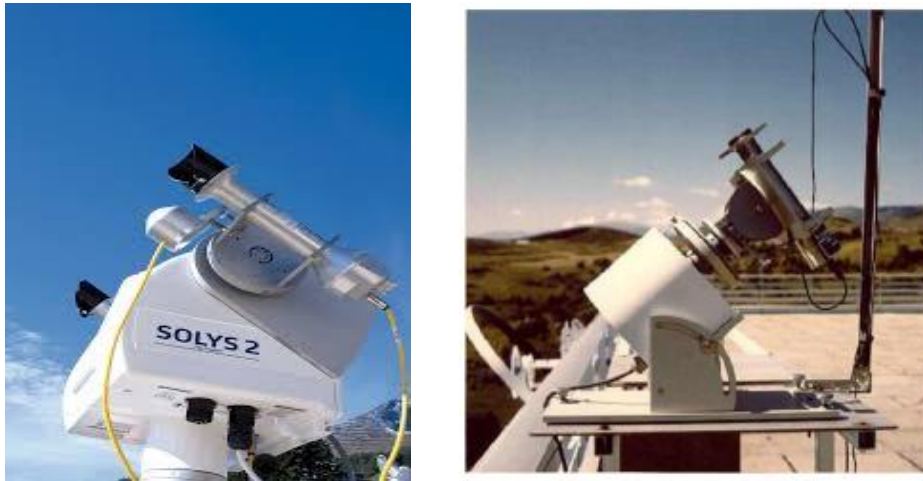
Figure I. 9. Pyrhéliomètre installé sur son support et exposé au soleil
