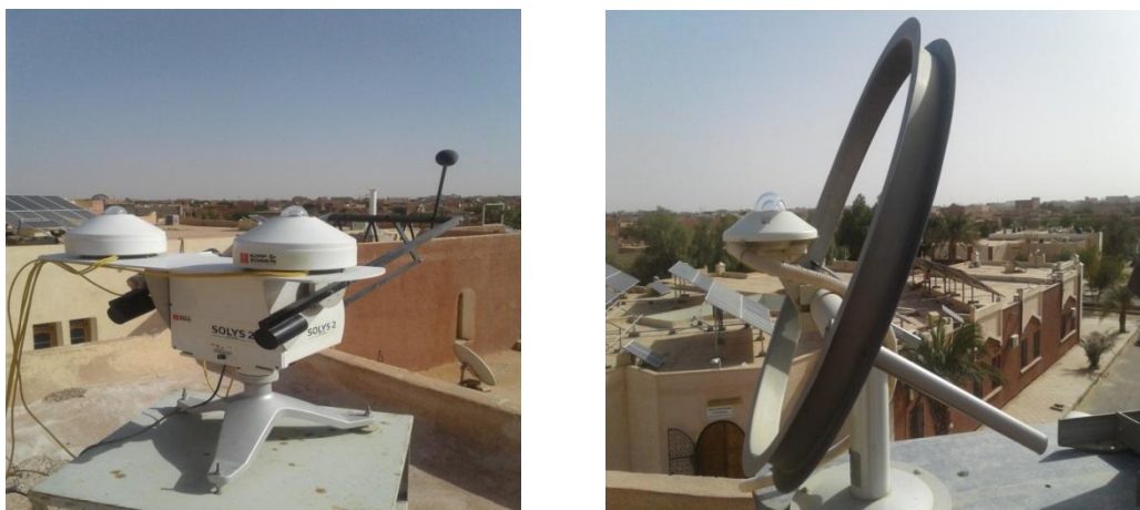
Figure I. 10. Pyranomètre (avec bonde pare soleil (à droite), avec boule (à gauche))
