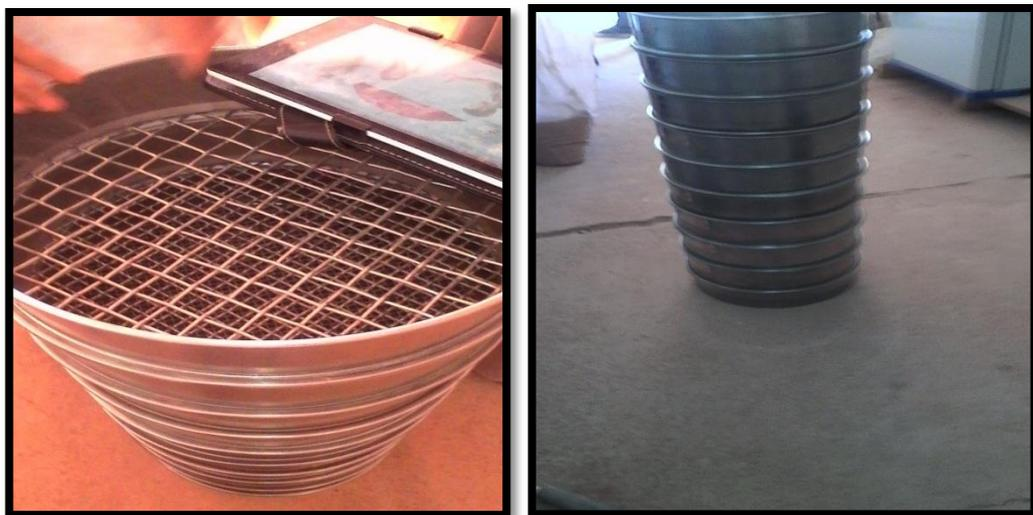
**Photo II.9 :** Photos présentant le mode opératoire de l'essai d'analyse granulométrique de sable bouda
