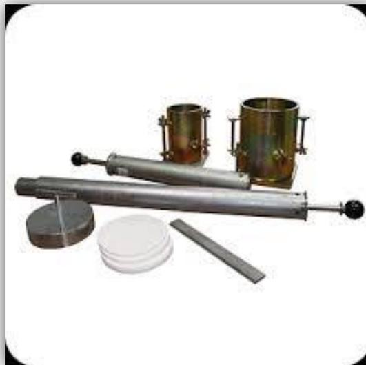
**Figure III.2:** Appareillage de l'essai proctor
