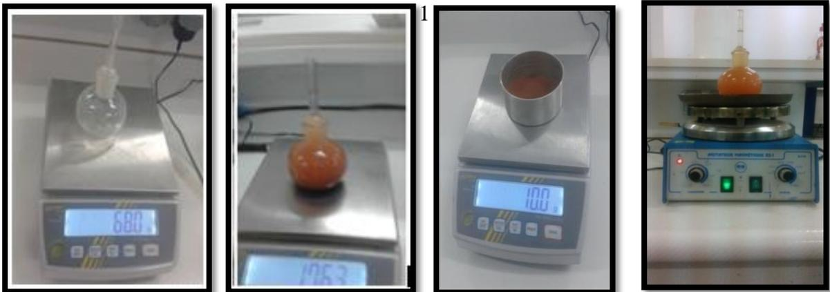
**Photos II.1:**Présent l'essai de poids spécifique des grains solides.
