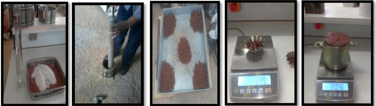
**Photos III.2:** Photo présentant le mode opératoire de l'essai proctor modifié
