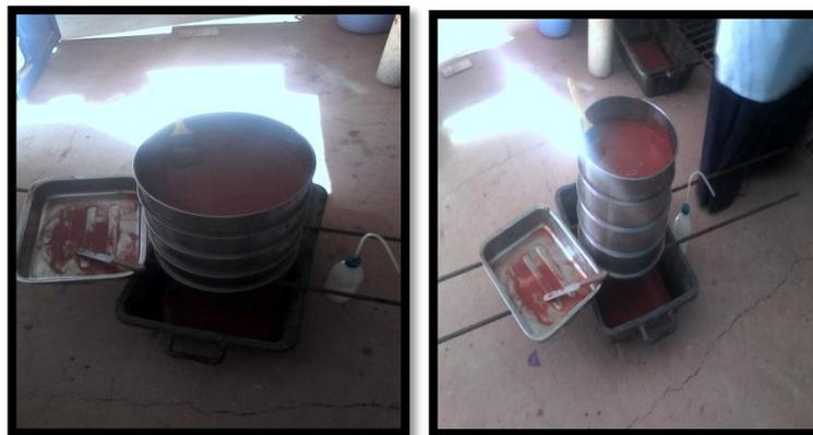
**Photo II.6:** Photos présentant le mode opératoire de l'essai de tamisage (par voie humide)
