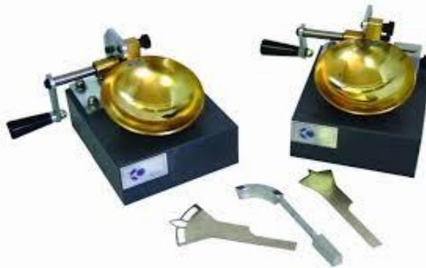
**Photo II.2:** Appareil de casagrande
