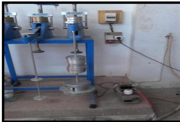
**Photo IV.2 :** Photo présentant le mode opératoire de l'essai de compressibilité oedométrique
