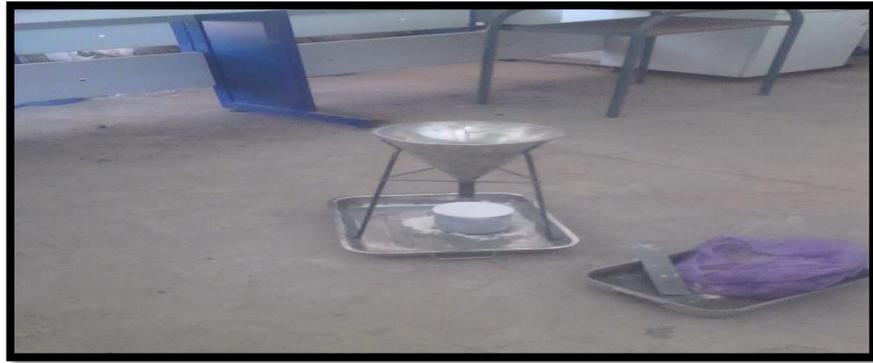
**Photo II.12** : Photos présentant le mode opératoire de l'essai de la masse volumique apparente
