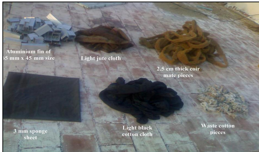
Figure II.22 Différents matériaux utilisés dans le distillateur [85]
