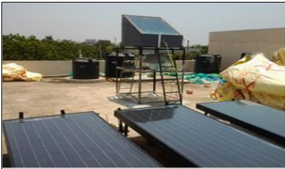
Figure II.14 Distillateur solaire couplé avec des collecteurs en séries [70]
