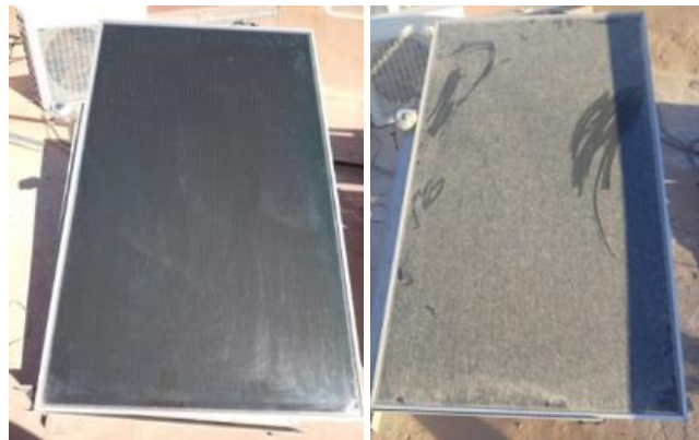
Figure IV.18. Modules exposés sous ensoleillement après un an sans nettoyage.
