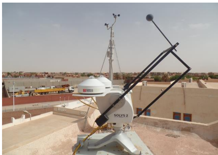
Figure IV.11 : Photo de la station météorologique (NEAL) installée dans l'URERMS Adrar.
