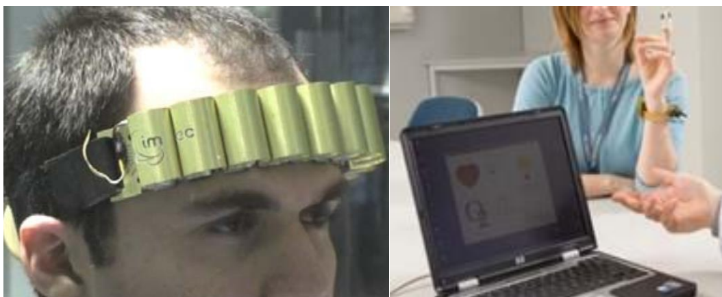
Figure I-13 : (gauche) TEG alimentant un système d'EEG monté sur un bandeau extensible [101] ; (droite) Oxymètre de pouls sans fil [102]
