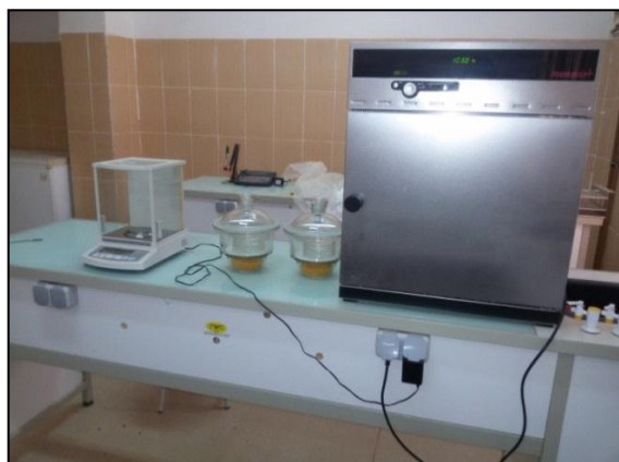
Figure 17- Matériel utilisé pour la détermination du taux d'humidité
