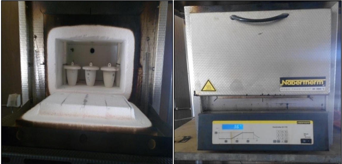
Figure 18- Matériel utilisé pour la détermination du taux de cendre
