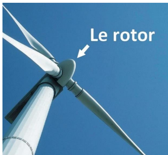
Figure I. 10: Le rotor d'une éolienne.
