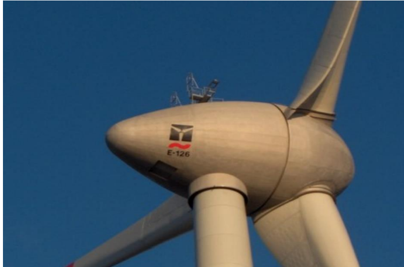
Figure I. 11: La nacelle d'une éolienne.
