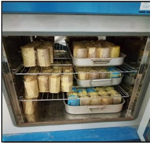
Photo III.3 : Cure à l'étuve des éprouvettes (Argile -Sable-Chaux).
