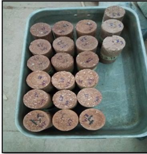
Photo III.2 : la conservation des éprouvettes (Argile +Sable).
