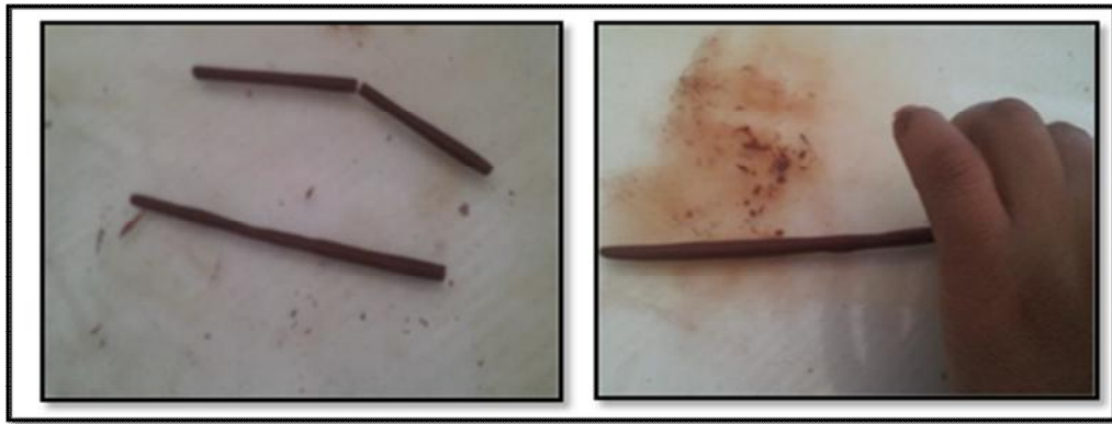
Photo II.7 : Mode opératoire de la limite de plasticité.
