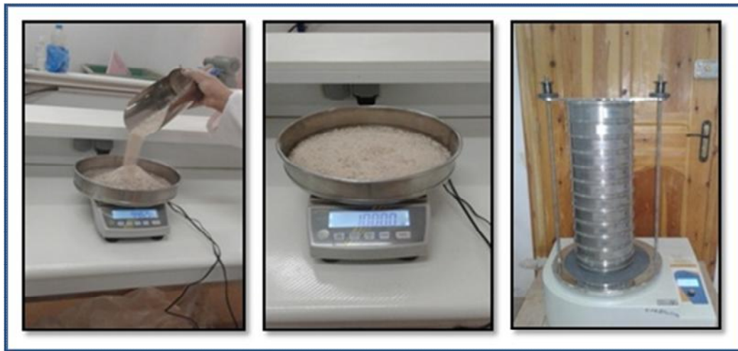
Photo II.16: Analyse granulométrique du sable concassé.
