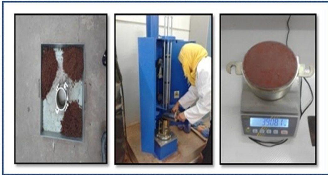
Photo II .9: Mode opératoire de Proctor normal.
