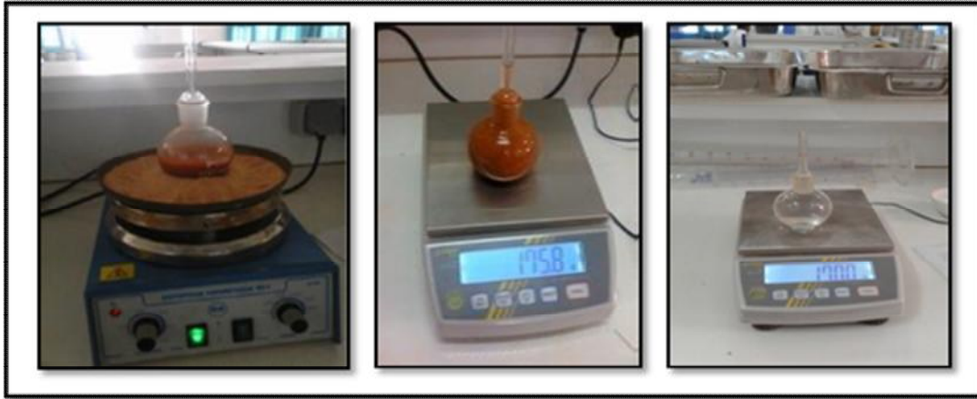
Photo II.5: Détermination du poids volumique des grains solides.
