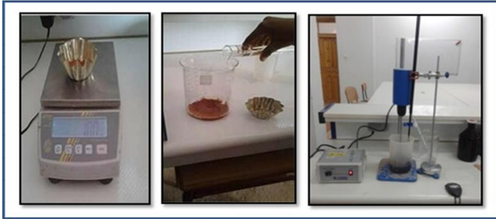
Photo II.10: Mode opératoire de l'essai de bleu méthylène.
