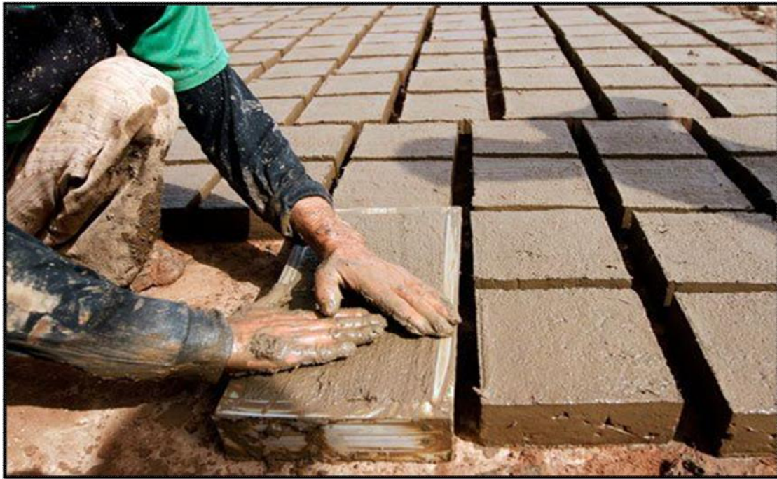
Photo I.2: Fabrication de l'adobe .
