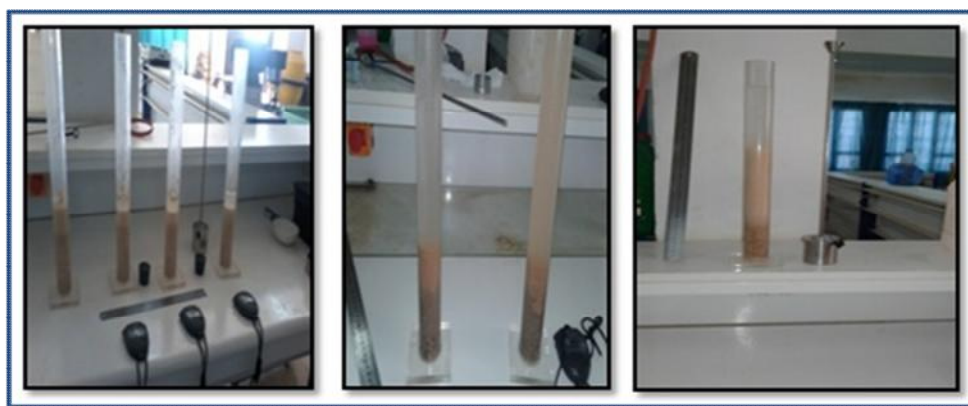
Photo II.15: Essai d'équivalent du sable.
