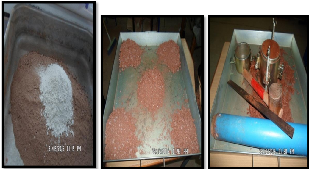
PhotoV.2 : Photos présentant le mode opératoire de l'essai de proctor des mélanges
