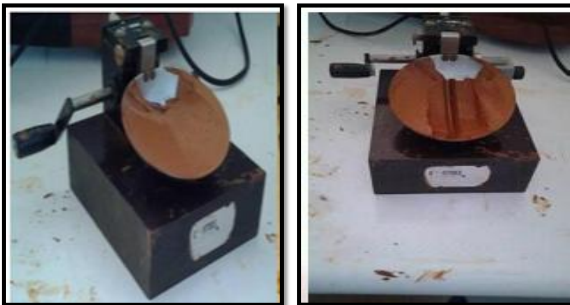
Photo (III.3): Le mode opératoire de l'essai de limite de liquidité
