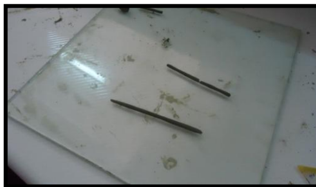
Photo III.4 : Mode opératoire de la limite de plasticité
