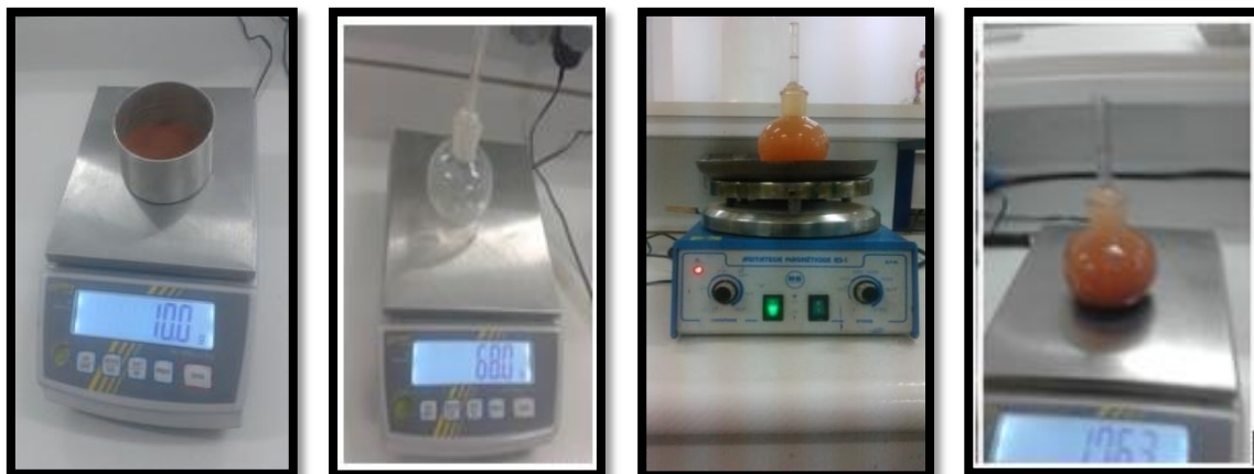
Photos III.1 : Le mode opératoire pour calculer le poids spécifique des grains solides.
