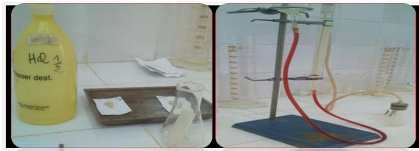
**Photo III.05:**Appareillage de l'essai de la teneur en  $\text{CaCO}_3$ .
