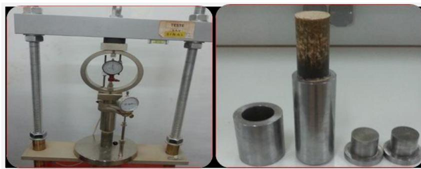
**Photo III.23:** Démoulages et écrasements des éprouvettes.
