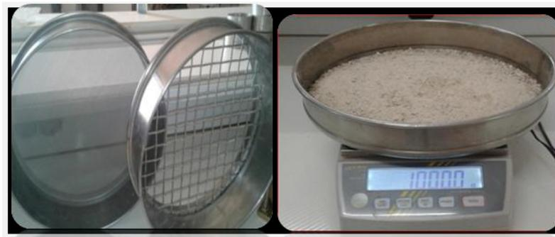
**Photo III.17:**Séparation des dimensions des grains.
