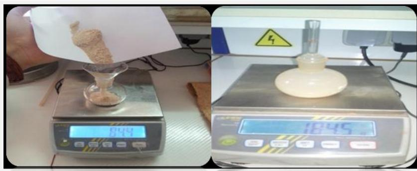
**Photo III.04:** Réalisation l'essai  $\gamma_{ab}$  pour les tufs.
