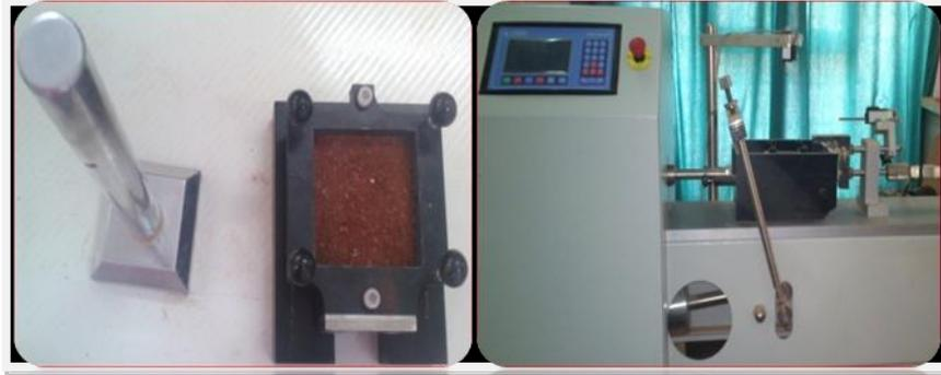
Photo III.21: L'essai de cisaillement à la boîte.
