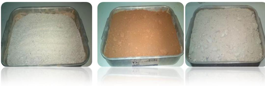
**Photo I.01 :** Sable concassé.**Photo I.02 :** Argile.**Photo I.03 :** Tuf.**I.3 DEFINITION DES MATERIAUX LOCAUX UTILISENT :****I.3.1 Tufs :**
