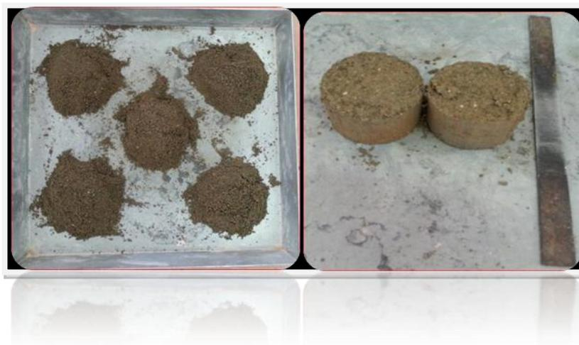
**Photo III.20:** préparation et compactage des échantillons.
