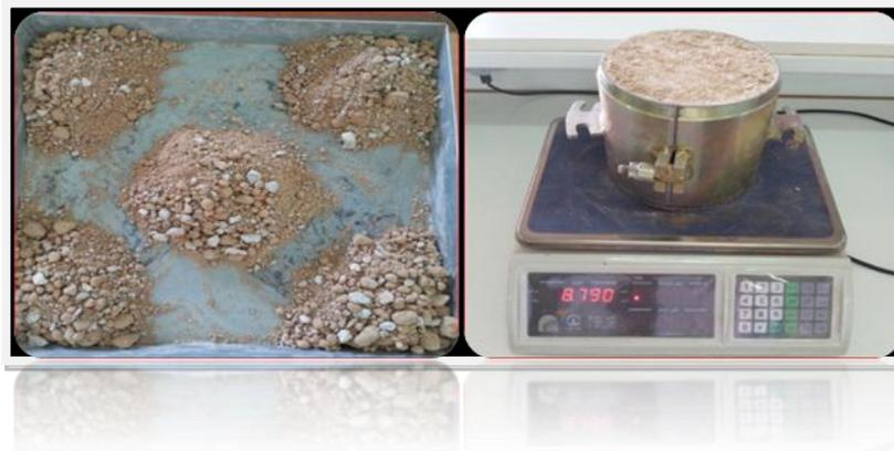
**Photo III.07:** Matériels d'essai Proctor modifié.
