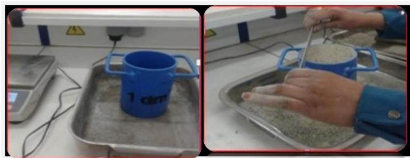
**Photo III.19:** Moule de l'essai lamasse volumique apparente et arasage des échantillons.
