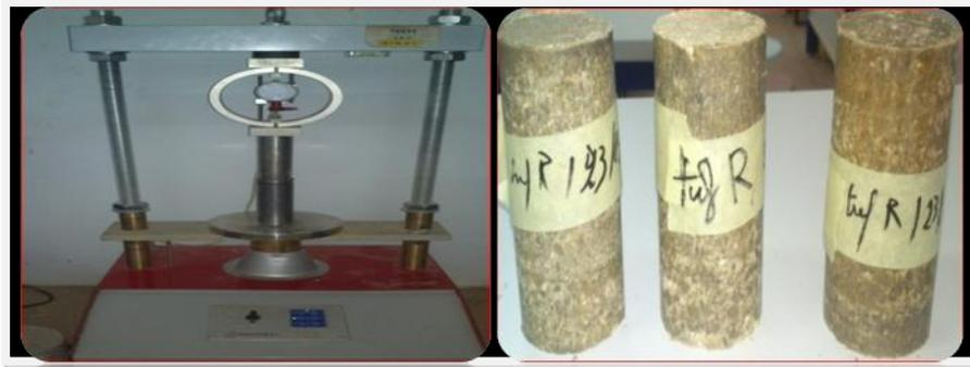
**Photo III.22:** Compactage des éprouvettes dans la presse CBR.
