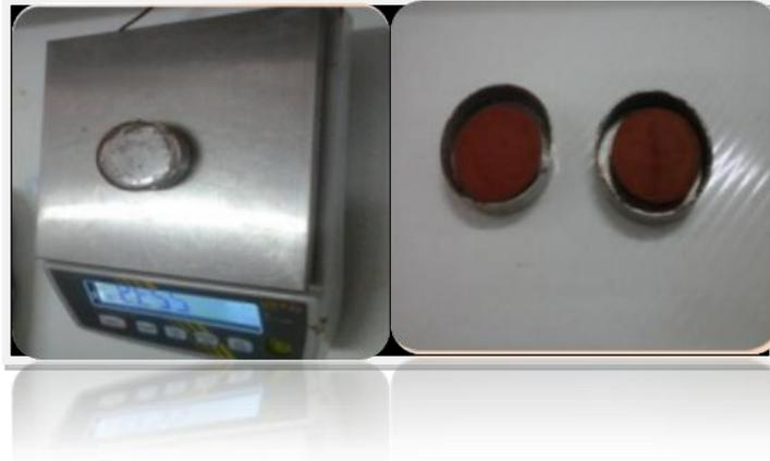
**Photo III.13:** Mode opératoire de la limite du retrait des argiles.
