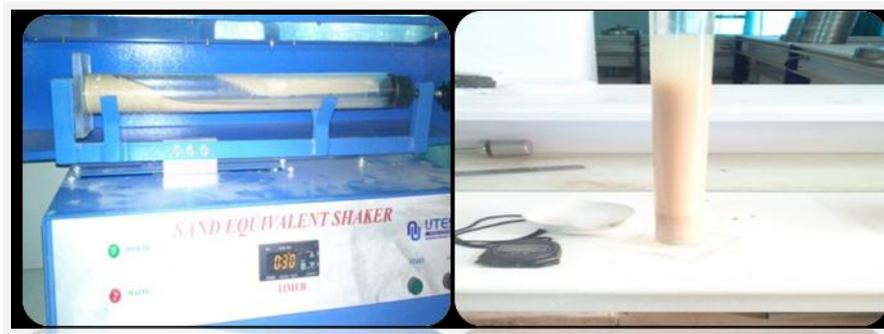
**Photo III.03:** Appareil d'agitation et l'éprouvette d'équivalent du sable.
