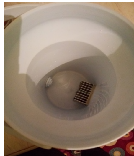
Figure IV.5 : Absorbeur installé dans l’enceinte
