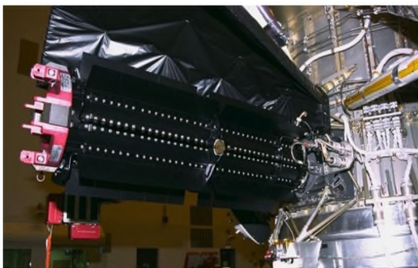
Figure I.6: Représentation et description d'un RTG
